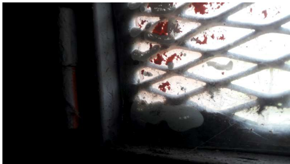
Prélèvement - P45 : R-1 / OS1.16 - Mastic- (Absence d'amiante)
