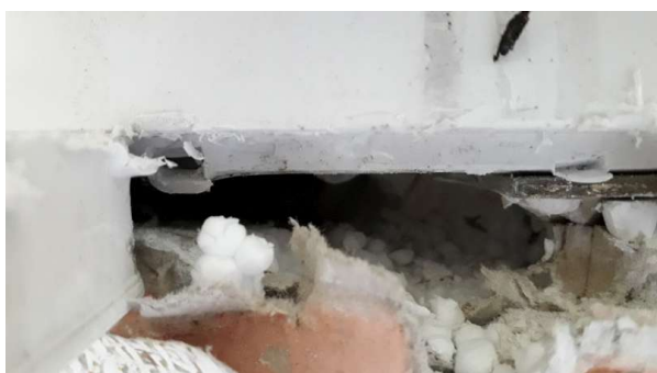
Prélèvement - P15 : R+1 / 01.009 - Plot de colle- (Absence d'amiante)
