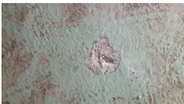
Prélèvement - P47 : R-1 / OS1.03 - Peinture- (Absence d'amiante)
