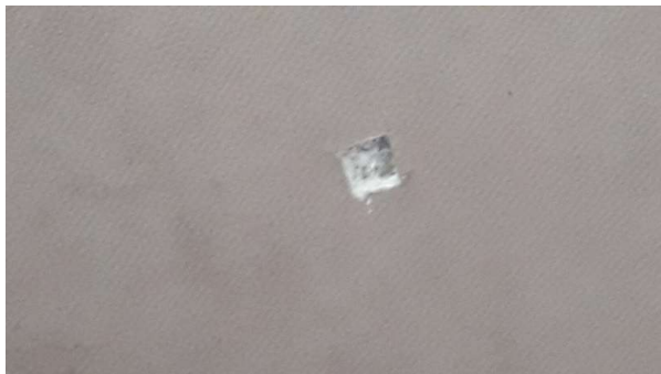
Prélèvement - P23 : R+1 / 01.010 - Mastic- (Absence d'amiante)
