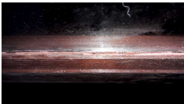
Prélèvement - P27 : R+1 / 01.026 - Mastic- (Absence d'amiante)
