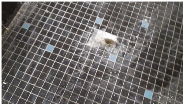
Prélèvement - P35 : R+0 / 00.021 - Colle de carrelage- (Absence d'amiante)
