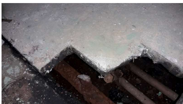
Prélèvement - P50 : R-1 / OS1.03 - Plaque de caniveau- (Présence d'amiante)
