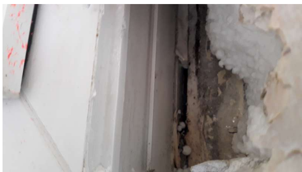
Prélèvement - P33 : R+0 / 00.020 - Plot de colle- (Absence d'amiante)
