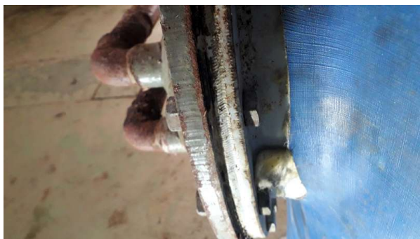
Prélèvement - P54 : R-1 / 0S1.03 - Joint- (Présence d'amiante)
