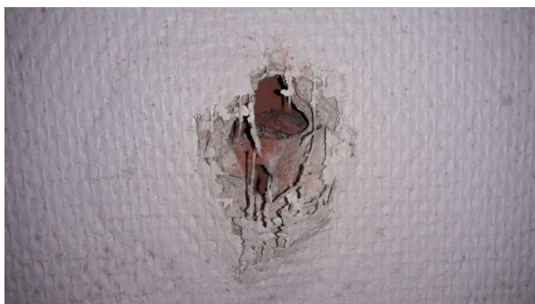
Prélèvement - P24 : R+1 / 01.026 - Peinture- (Absence d'amiante)
