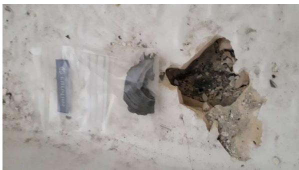
Prélèvement - P25 : R+1 / 01.010 - Revêtement bitumineux- (Absence d'amiante)
