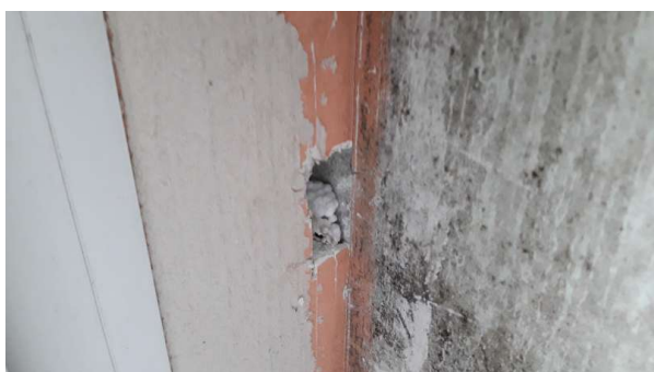
Prélèvement - P22 : R+1 / 01.009 - Bande de plaque de plâtre- (Absence d'amiante)
